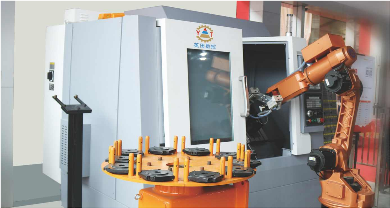
▶ 六关节机械手臂：配套工件夹具和自动料仓，自动完成工件上料和下料，大批量加工省时省力。
