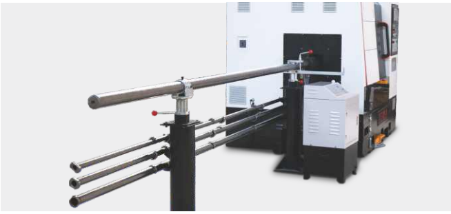
▶ 油浴式送料器： 送料长度≤3米，送料直径可达42MM，棒料在油液中旋转，自定心好，减少棒料和管壁的碰撞，棒料表面刮伤小，噪音低，送料平稳。
